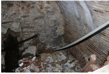
Ancien moulin à huile du sieur Tixedor, puis chocolaterie, puis usine électrique - Axe horizontal et barre de transmission conservés dans la chambre hydraulique du moulin à huile 1). Phot. Léonie Deshayes IVR76_20216665055NUCA
